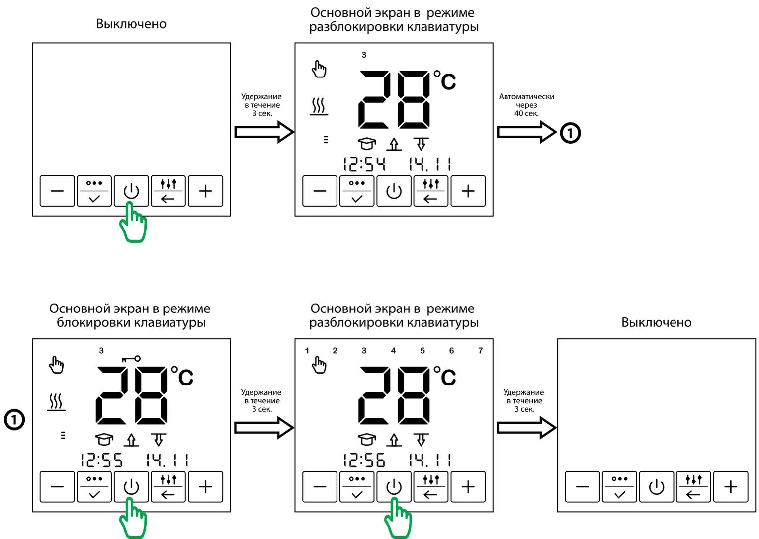
Рис. 9 Включение – блокировка – разблокировка – выключение
