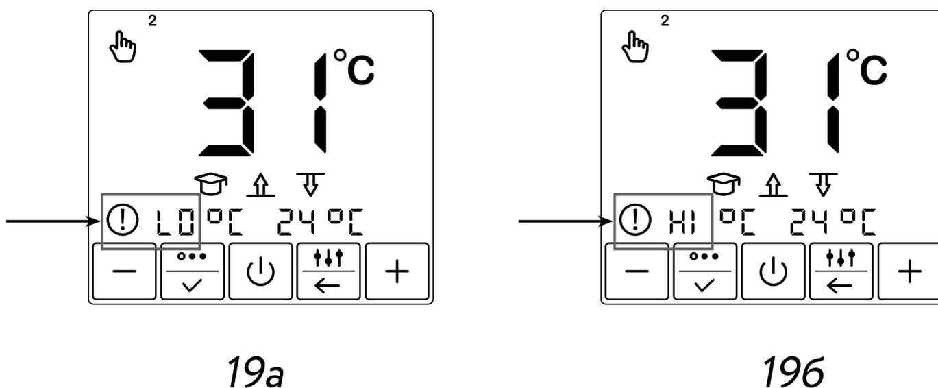
Рис. 19 Обрыв (а), замыкание (б) датчика обогрева
