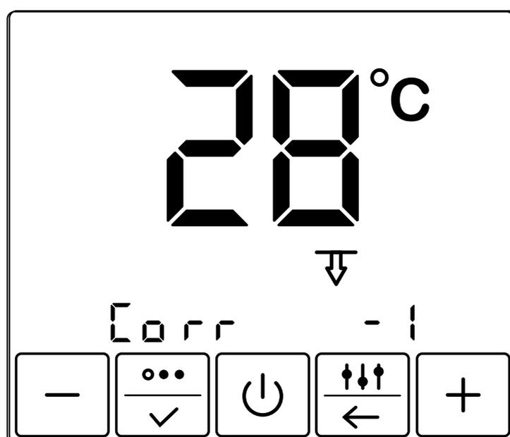
*Рис. 15. Режим корректировки показаний температуры воздуха*
