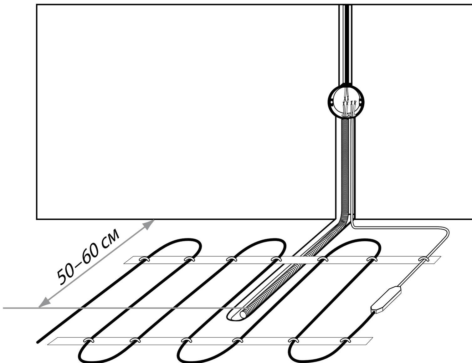
Рис. 1 Монтаж датчика температуры
